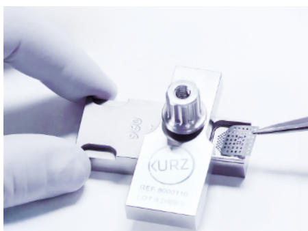
Изображение 3: Толщина хрящевого трансплантата = 0,7 мм минус толщина использованных дистанционных шайбочек
